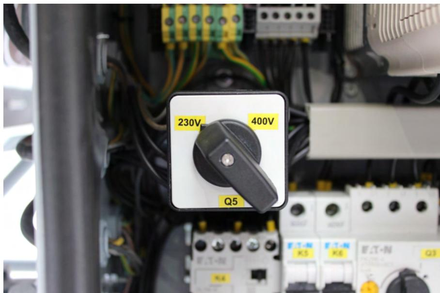
Для того, чтобы изменить напряжение, следует Установите главный выключатель в положение "0". Установите переключатель напряжение **Q5** 230 В/400В. Установить главный выключатель в положение "1". Нажать кнопку START.
