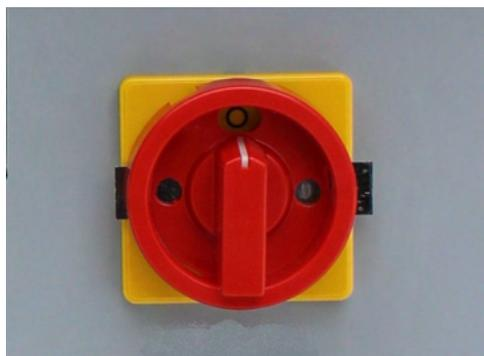
Главный поворотный выключатель (34.) установите в положение «I» («Включено») Если горит **желтая лампа (2)** "Изменить направление вращения", следует сделать следующее: главный поворотный выключатель (34.) необходимо перевести в нулевое положение, переместить фиксирующую его планку, и снова включить его (в противоположную от первоначального направления сторону). Тем самым направление вращения изменено на верное.
